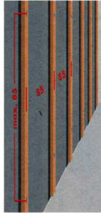
7. Direktmontage der Holzlatte, Lattenabstand bzw. Schraubenabstand hier 850 mm
