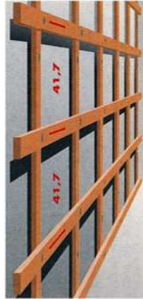
8. Konterlatte mit dem Achsabstand 417 mm
