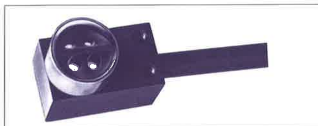
Reflexions-Lichttaster mit Doppeloptik für kombinierte Anlage- und Frühbogenkontrolle, wie er unter dem Anlagetisch eingebaut wird.
